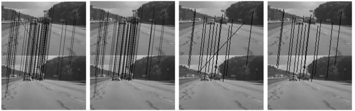
(a)原 SURF 算法 (b)改进的 SURF 算法 (c)降低尺度后的原 SURF 算法 (d)降低尺度后的改进 SURF 算法 (a) SURF algorithm (b)Optimized SURF algorithm (c) Down-sampled SURF algorithm (d) Down-sampled optimized SURF algorithm
